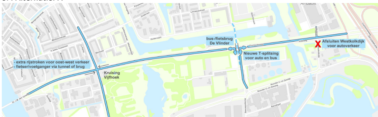
Figuur 3-5: Schematische weergave van Alternatief A waarbij alleen gelijkvloerse uitbreidingen en aanpassingen voor het wegverkeer zijn toegepast.
