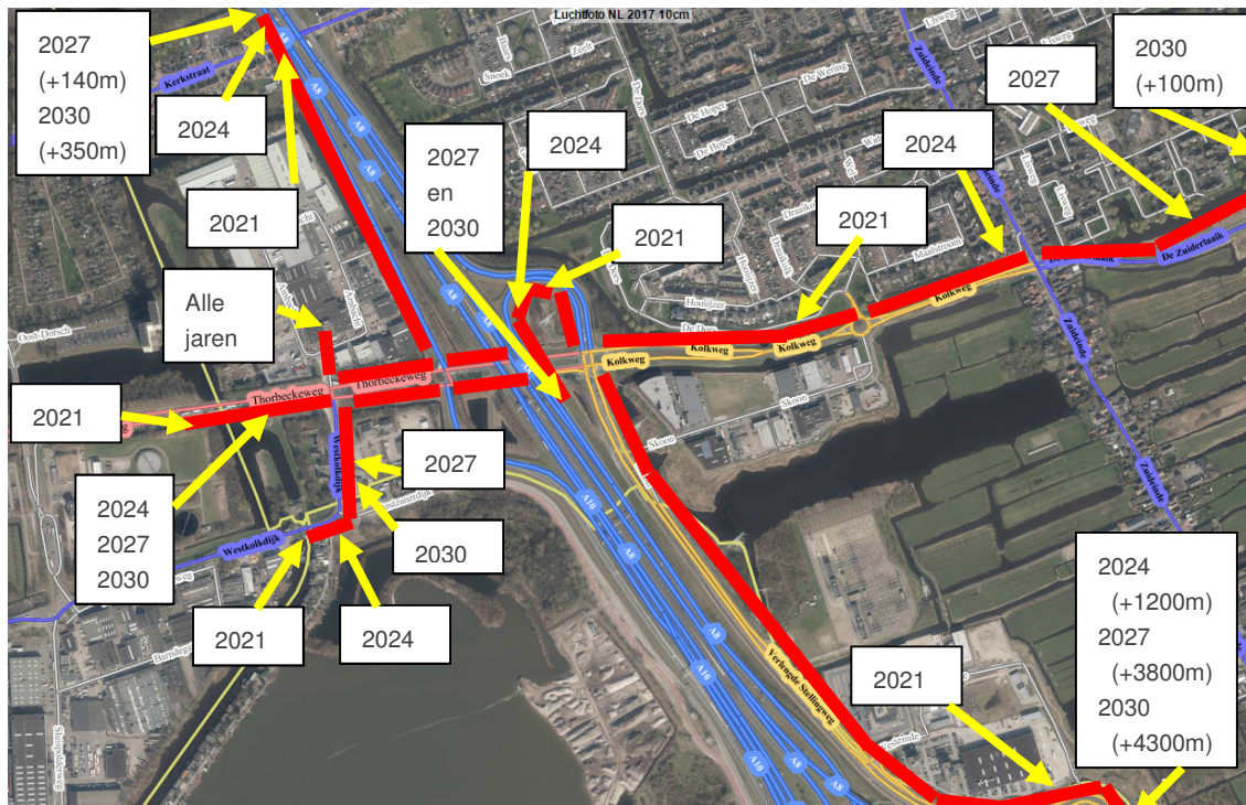
Figuur 3.2: Maximale wachtrij ochtendspits voor 2021, 2024, 2027 en 2030 (rode balk is maximale wachtrij, gele pijl de staart vd rij naar jaar)
