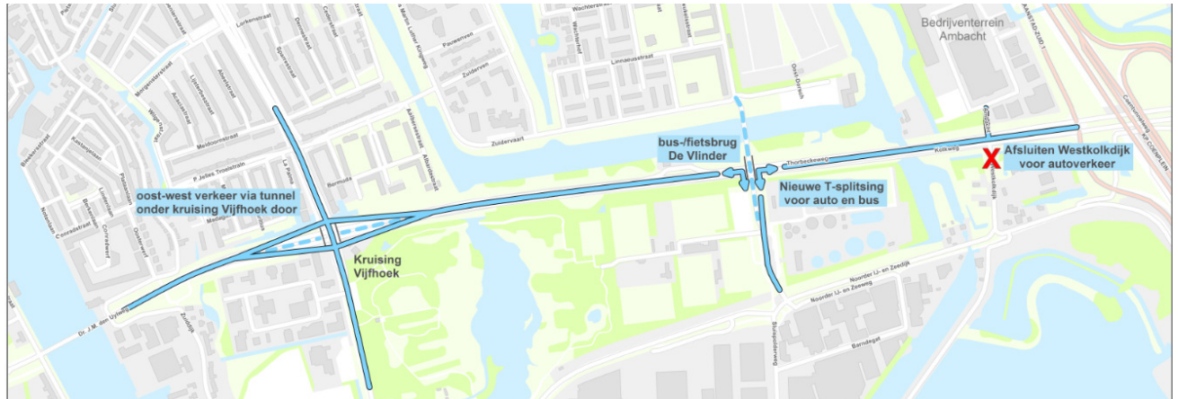
Figuur 3-8: Schematische weergave van Alternatief B waarbij rond de Vijfhoek een ongelijkvloers kruispunt wordt gerealiseerd en de aansluiting Westkolkdijk verplaatst wordt naar de Vlinderbrug.
